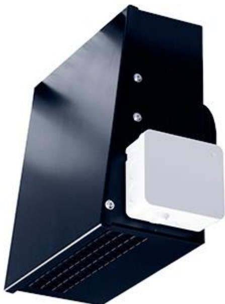
Настенные вентиляторы RS EC оснащены электронно-коммутируемым двигателем (EC-двигателем) с внешним ротором и рабочим колесом с загнутыми назад лопатками. Корпус вентиляторов изготавливается из оцинкованной стали, дополнительно окрашивается в черный цвет.
