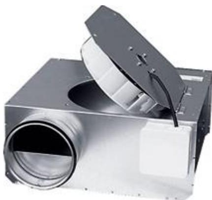
Низкопрофильные каналные вентиляторы LPKB оснащены асинхронным двигателем с внешним ротором и рабочим колесом с загнутыми назад лопатками. Двигатель и рабочее колесо вентилятора расположены на откидывающейся пластине, что делает доступ к ним лёгким, быстрым и удобным. Корпус вентиляторов изготавливается из оцинкованной стали.
