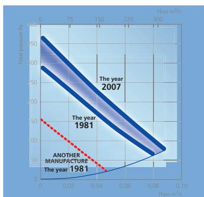
Развитие прямоточного круглого канального вентилятора СК с размером канала 100 мм. До 1981 года самая распространённая модель на рынке имела низкое давление и слабый расход воздуха. В 1981 году появилась усовершенствованная модель «AB C.A. Östberg», которая имела гораздо более высокое давление и больший расход воздуха.
